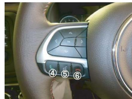
左右裏側のステアリングスイッチの①と②、右裏側のステアリングスイッチの③をナビゲーションと連動して使用できます。左側のステアリングスイッチの④・⑤・⑥はナビゲーションのステアリング学習機能があれば使用する事が可能です。
